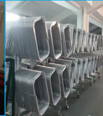
铝合金车窗表面涂装 ( powder coating )
