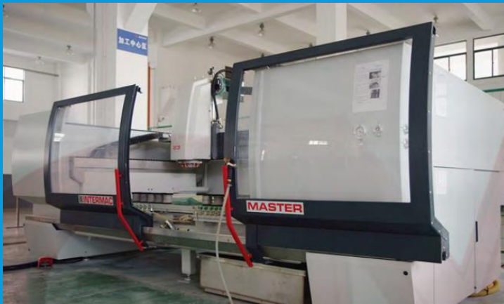
意大利进口 Intermac 加工中心 CNC glass edge grinding
