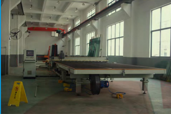
意大利进口 Intermac 加工中心 CNC glass edge grinding
